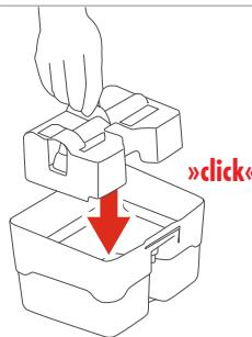
Установить вставку для защиты от расплескивания в резервуар для грязной воды прямо сверху на всасывающий фильтр.
